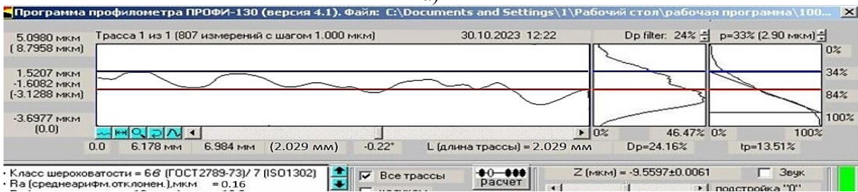
Рис. 3. Профилограммы поверхности образцов из стали 45 до (а) и после (б) ультразвуковой обработки
